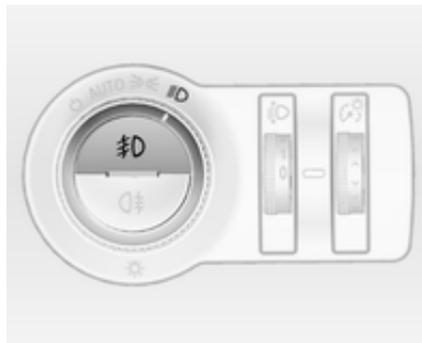
Включается с помощью кнопки  $\#D$ . Переключатель освещения находится в положении **AUTO**: при включении передних противотуманных фар основные фары включатся автоматически.
