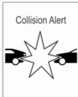
При быстром сближении с другим транспортным средством на дисплее информационного центра водителя начинает мигать индикатор системы предупреждения о столкновении. Одновременно раздается предупредительный звуковой сигнал. Будьте готовы начать торможение в соответствии с ситуацией на дороге.
