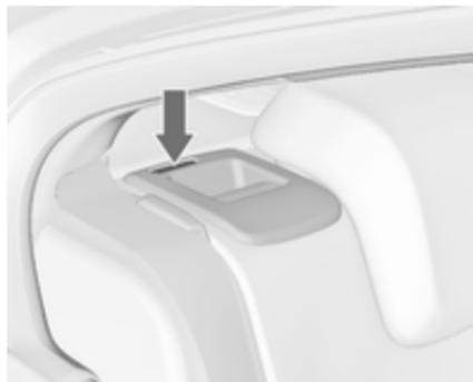
Спинки сидений зафиксированы правильно, если оба красных маркера сбоку рядом с рычагом освобождения не видны.
