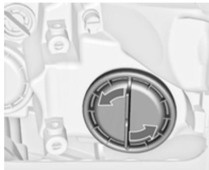
1. Поверните колпачок **1** против часовой стрелки и снимите его.
