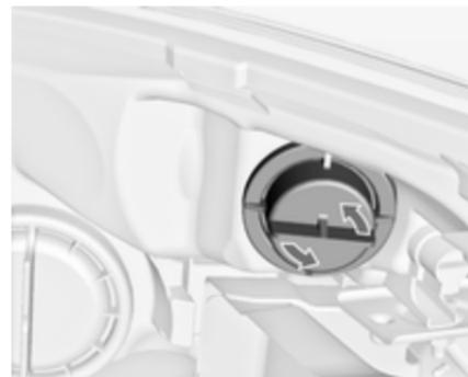
1. Поверните колпачок против часовой стрелки и снимите его.
