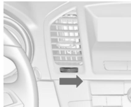
Чтобы открыть вентиляционное отверстие, следует повернуть колесико регулятора в положение I. Регулировка количества воздуха, выходящего из вентиляционных отверстий, выполняется колесиком регулятора.
