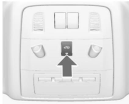
Следует выключить контроль пассажирского салона и наклона автомобиля, если внутри салона вы оставили животное, так как вредные для него ультразвуковые сигналы имеют высокую мощность, а движение животного может привести к срабатыванию противоугонной сигнализации. Систему также следует выключить при перевозке автомобиля на пароме или железнодорожным транспортом.
