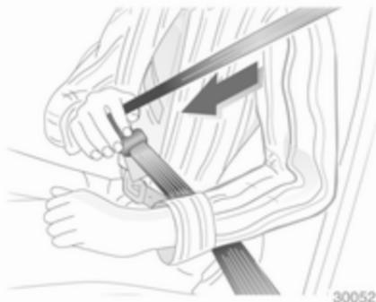
Вытянуть ремень безопасности из подматывающего механизма, не перекручивая направить его поперек туловища и вставить язычок застелки ремня безопасности в пряжку. Во время движения автомобиля следует регулярно подтягивать поясную часть ремня, вытя-
