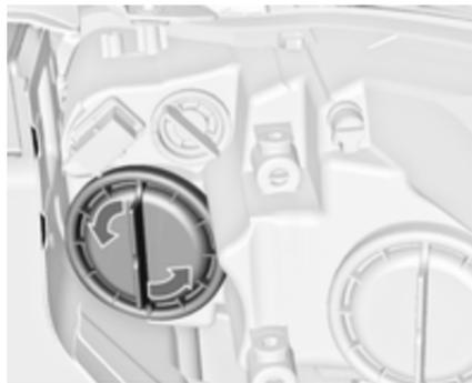
1. Поверните колпачок **2** против часовой стрелки и снимите его.
