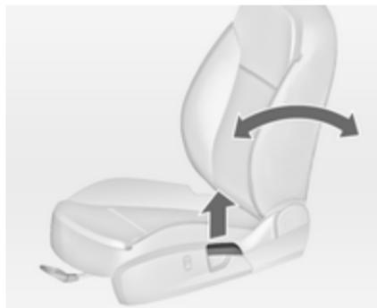
Потяните рычаг, отрегулируйте наклон и отпустите рычаг. Сиденье должно зафиксироваться в новом положении с характерным щелчком.
