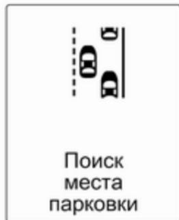
Когда автомобиль с включенной системой проезжает мимо ряда припаркованных автомобилей, усовершенствованная система облегчения парковки начинает искать подходящее свободное место для парковки. После того как свободное место будет обнаружено, посредством информационного центра водителя подаются звуковые и визуальные предупредительные сообщения.
