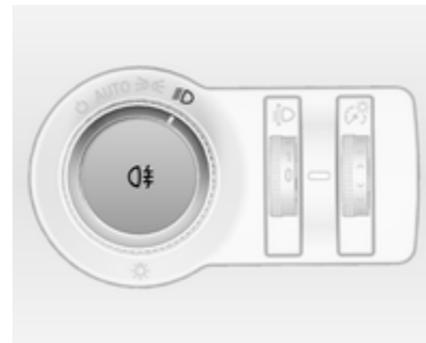
Включается с помощью кнопки  $D\#$ . Переключатель освещения находится в положении **AUTO**: при включении заднего противотуманного фонаря основные фары включатся автоматически.
