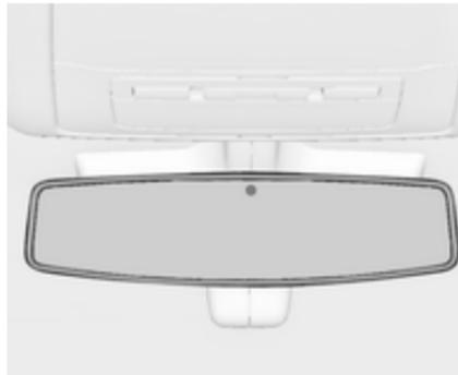
В темное время суток автоматически снижается ослепление водителя фарами едущих сзади автомобилей.
