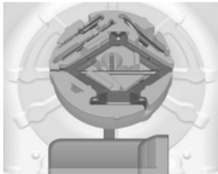
Домкрат и водительский инструмент уложены в ящик в багажном отделении под запасным колесом. Запасное колесо ⇨ 234.
