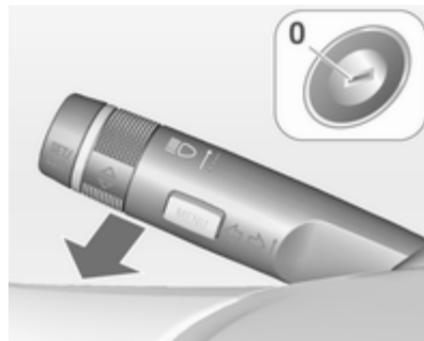
Передние фары, задние габаритные огни и фонари подсветки номерного знака осуществляют подсветку пути водителю. Продолжительность интервала, в течение которого огни остаются включенными, может регулироваться.
