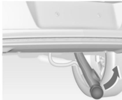
Ладонью руки поверните освобожденную сцепную тягу с шаровой опорой вправо до фиксации под углом автомобиля. Убедитесь, что рукоятка освобождения находится в скрытом первоначальном положении, в противном случае звуковой сигнал не отключится.
