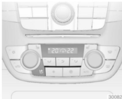
Для установки нужного уровня вентиляции сиденья нажмите один или несколько раз на кнопку
