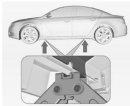
3. Проследите, чтобы домкрат был установлен в точках поддомкрачивания автомобиля.
