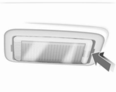
1. Извлеките фонарь с помощью отвертки.
