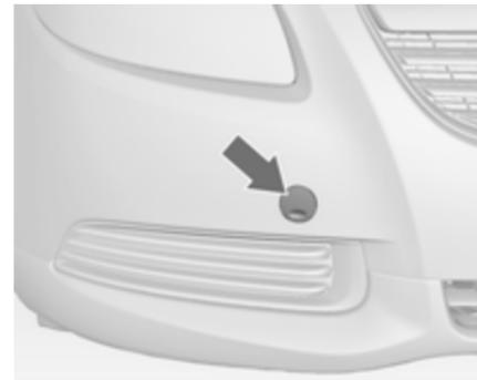
Отцепите крышку снизу и снимите вниз.
