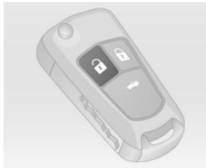
Чтобы отпереть двери и багажное отделение, нажмите на кнопку
