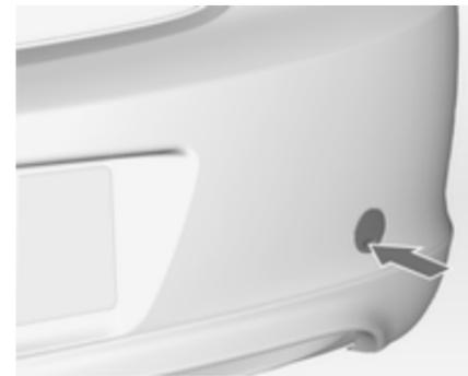
Отцепите крышку снизу и снимите вниз.
