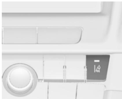
Если система определяет, что имеет место непреднамеренный выход за пределы полосы движения, цвет контрольного индикатора
