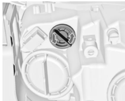
1. Поверните патрон лампы против часовой стрелки и выньте.
