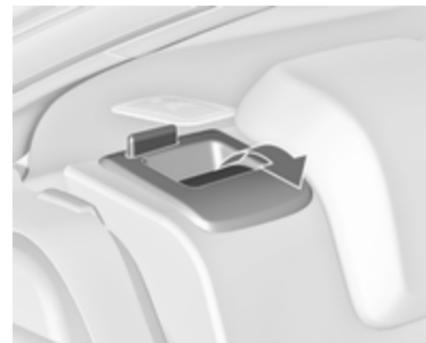
Чтобы поднять спинки сидений, их следует разложить вверх и установить в вертикальное положение до фиксации со щелчком.
