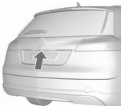
Чтобы открыть заднюю торцевую откидную дверь, нажмите и удерживайте сенсорный выключатель под молдингом задней торцевой откидной двери, пока дверь не начнет перемещаться.
