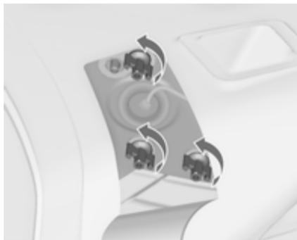
2. Вручную отвинтите три пластиковые крепежные гайки.
