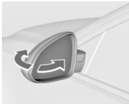
Для обеспечения безопасности пешеходов, внешние зеркала складываются от удара определенной
