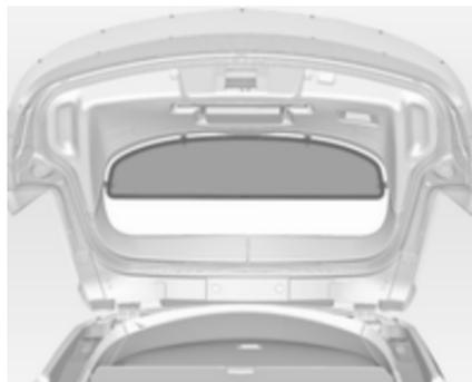
Чтобы полностью закрыть багажник, следует установить шторку на четыре крепежные точки с внутренней стороны задней торцевой откидной двери.
