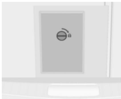
Закрытую крышку можно закрепить сбоку багажного отделения. Повернуть ручку на 90°:
