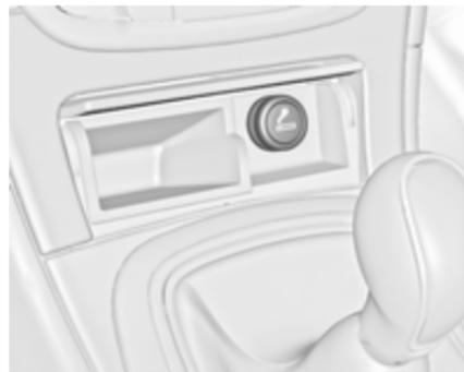
Нажать на прикуриватель. Он выключится автоматически после нагревания спирального элемента. Извлеките прикуриватель.
