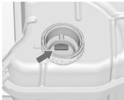
В других модификациях системы заправочная метка расположена внутри отверстия заправочной горловины. Для проверки откройте крышку отверстия.
