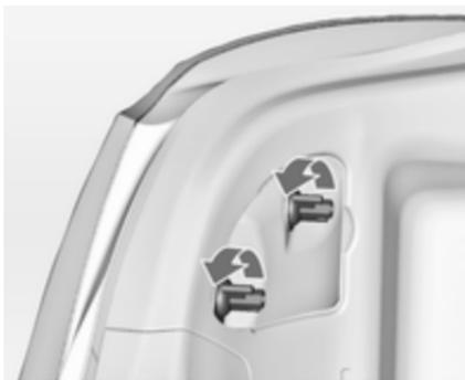
2. Открутите рукой две пластиковые гайки крепления с внутренней стороны.
