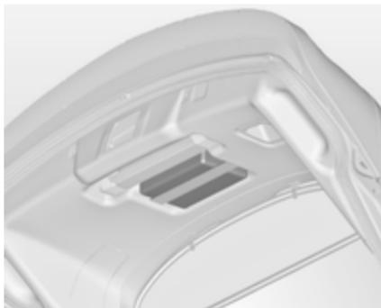
Храните аптечку в пространстве за ремнем на внутренней стороне заднего фонаря.
