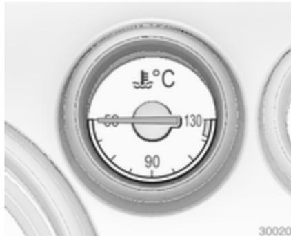
Отображает температуру охлаждающей жидкости двигателя.
