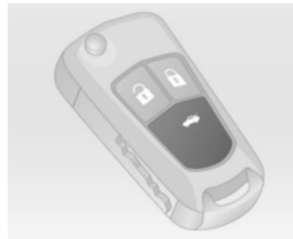
При выключенном зажигании нажать кнопку
