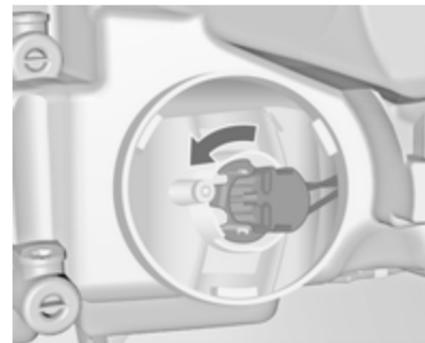
2. Поверните патрон лампы против часовой стрелки, пока он не освободится. Выньте патрон лампы из отражателя.
