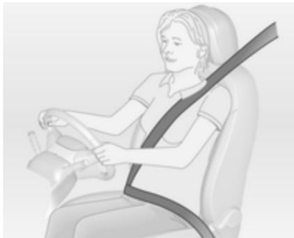
Вытяните ремень безопасности и зафиксируйте его в замке. Ремень безопасности не должен быть перекручен и должен быть плотно подогнан к телу. Спинку сиденья не следует отклонять назад слишком далеко (не более чем примерно на 25°).
