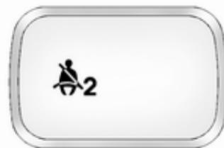
Если при работающем двигателе на переднем сиденье находится пассажир, не пристегнутый ремнем безопасности, сигнализатор
