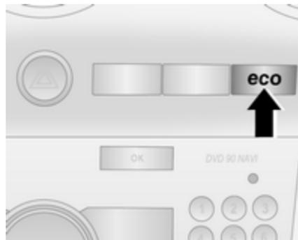
Чтобы принудительно отключить систему автоматической остановки и пуска двигателя, нажмите клавишу **eco**. Если система отключена, светодиод подсветки клавиши гаснет.
