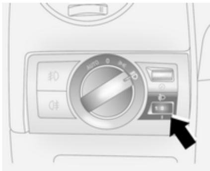
При включенном ближнем свете скорректируйте угол наклона светового пучка в соответствии с загрузкой автомобиля. Правильная регулировка света фар помогает снизить ослепление водителей других транспортных средств.
