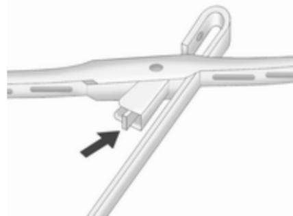
Поднять рычаг стеклоочистителя, прижать и удерживать нажатым зажимное приспособление, отсоединить щетку.
