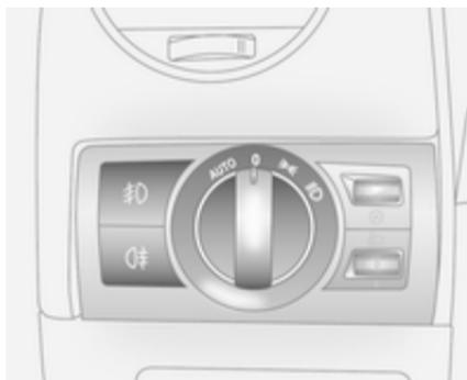
Поверните выключатель освещения:
