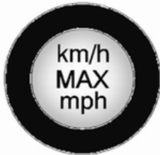
10. Снимите с баллона для герметика наклейку, на которой указана максимально допустимая скорость движения, и приклейте ее в поле зрения водителя.
