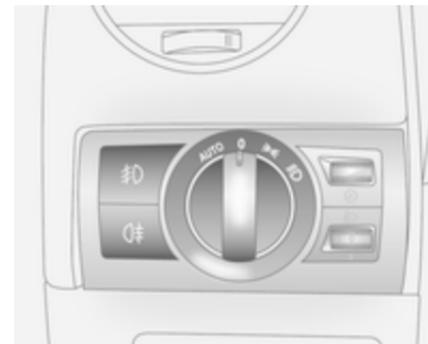
Поверните выключатель освещения
