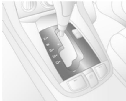
**P** = положение для парковки, колеса заблокированы, допускается устанавливать только на стоящем автомобиле с включенным электромеханическим стояночным тормозом
