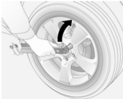
10. Установите колесный ключ, убедитесь, что он встал надежно, и затяните колесные гайки крест-накрест. Болты следует затягивать моментом 140 Нм.
