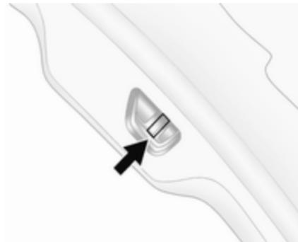
Чтобы открыть дверь багажного отделения при пропадании напряжения в бортсети: Снимите обивку в районе центрального замка и надавите на рычаг подручным инструментом.
