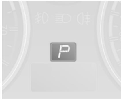
На дисплей коробки передач выводится режим ее работы и выбранная передача.
