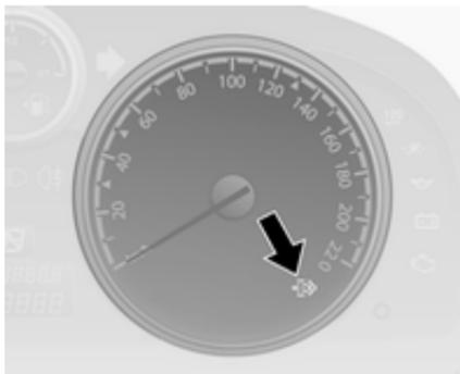
При определенных режимах движения, например, при езде на короткие расстояния, система автоматически очищаться не может.
