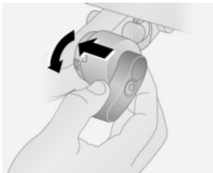
Разблокировать шаровую опору и вынуть ключ. Нажмите на рычаг фиксатора влево к тягово-сцепному устройству и поверните его вниз. Вытяните тягово-сцепное устройство из гнезда.
