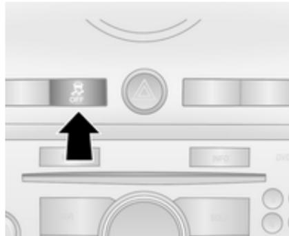
При включенной системе ESC, если колеса проскальзывают на влажных, заснеженных или обледеневших дорогах, обороты двигателя могут при нажатии на педаль газа не увеличиваться. Автомобиль может не двигаться с места.
