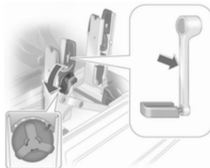
После установки поворотного рычага в ячейку коленчатого рычага вращения педали велосипеда приблизительно подогнать регулируемый блок коленчатого рычага вращения педали велосипеда в соответствии с выступом коленчатого рычага вращения педали велосипеда.
