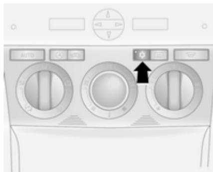
Параметры системы климат-контроля можно изменять нажатием клавиши
