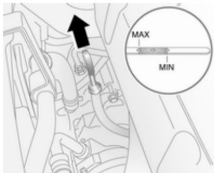
Двигатели различного типа комплектуются разными масляными щупами.
