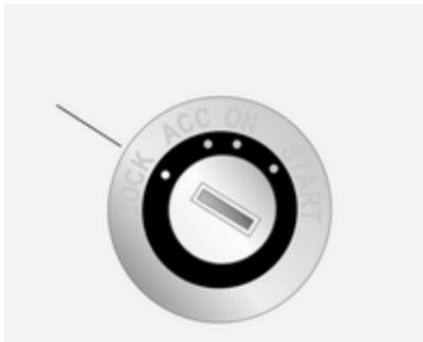
Встроенная в замок зажигания система проверяет, разрешается ли пуск двигателя с помощью используемого ключа. Если транспондер ключа распознан, двигатель запустится.
